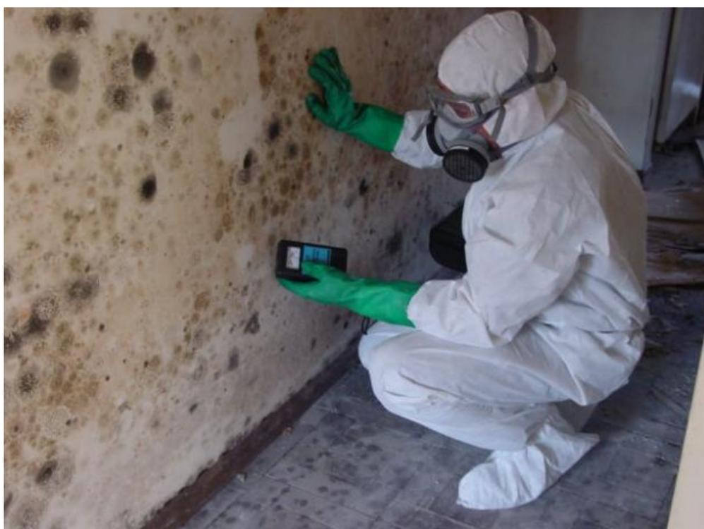
Opérateur en combinaison Type III cat 5/6, protection respiratoire P3 lors de mesures de l'humidité dans un mur avec prolifération de moisissures (recherche de la source d'humidité)
